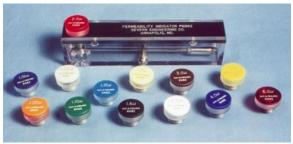
指标器的操作基于指标器的操作基于永久条形磁铁与已知标准样品和未知材料的相互吸引。在使用中,将插入件拧入壳体的顶部,然后依据插入件铁素/磁体值的力将磁铁吸引到插入件上,然后,从壳体底部的开口突出的磁铁的端部与被测材料接触,接触表面必须清洁并且没有氧化皮或异物,然后,指标器在垂直于接触表面的方向上移开,如果被测材料的铁素/磁体含量高于校准插件的铁素/磁体含量,则随着指标器移开,磁铁将完全与插件底部分离,当保持磁铁的金属套环撞击塑料外壳的底部时,会发生完全分离;如果被测材料的铁素/磁体含量低于插入值,则当指标器移开时,磁铁将首先与测试材料分离,因此通过更换插入件,可以归类待测材料的铁素/磁体含量。
